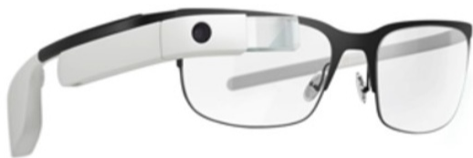
[구글 글라스] 디스플레이 모듈이 돌출되고 부품이 한쪽에 치우쳐 장시간 착용 시 불편
