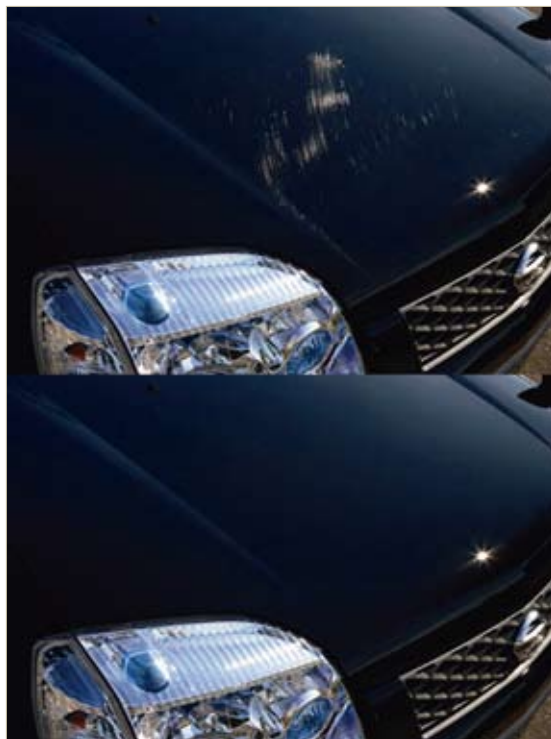
자기 치유 코팅된 자동차의 스크래치 회복 전후 모습 (닛산 자동차)
